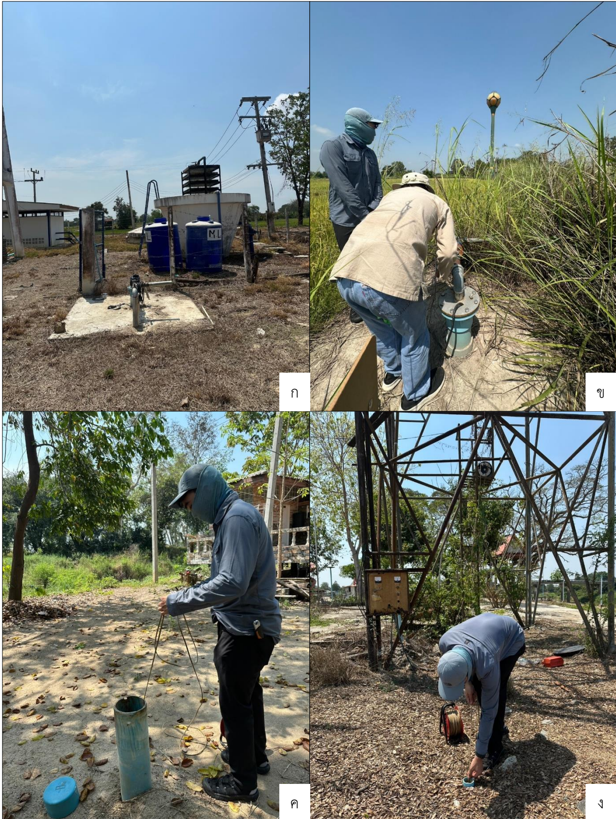
ภาพที่ 5.2.3-5 การวัดระดับน้ำใต้ดินจากบ่อบาดาลในพื้นที่โครงการประจวบฯ น้ำโพธิ์ประทับช้าง
